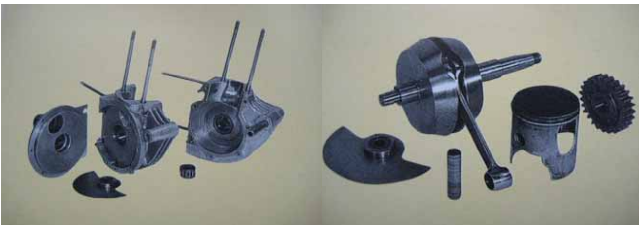
MZ-teknik: Motor med slidmatning för insug och utblås. Lagg märke till utskärningen i kolvsjortan! Den tekniken i samband med en tredje överströmningskanal och exakt avvägda expansionskammare startade MZ ett nytt tvåtakarliv inom tävlingssporten, såväl som för snabba brukscyklar
