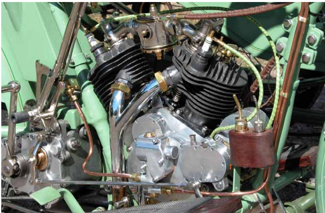
Motorn från schweiziska Moto-Rêve är närmast ett konstverk med alla sina vackra detaljer. Notera trähållaren till höger för små flaskor med extra smörjolja och bensin, bensinen för att kunna "snapsa" motorn.
