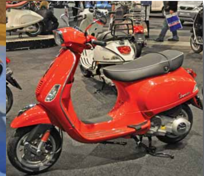
Smidig i stan. Vespa med självbärande karosseri i stålplåt och steglös automatlåda med variator.
